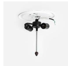
**1:** Met gebruikmaking van het oog op de draadspindel kan deze rechtstreeks aan de haak van de centraaldoos of, indien niet aanwezig, een schroefoog opgehangen worden. Wel moet de draadspindel eerst op lengte gemaakt worden.
