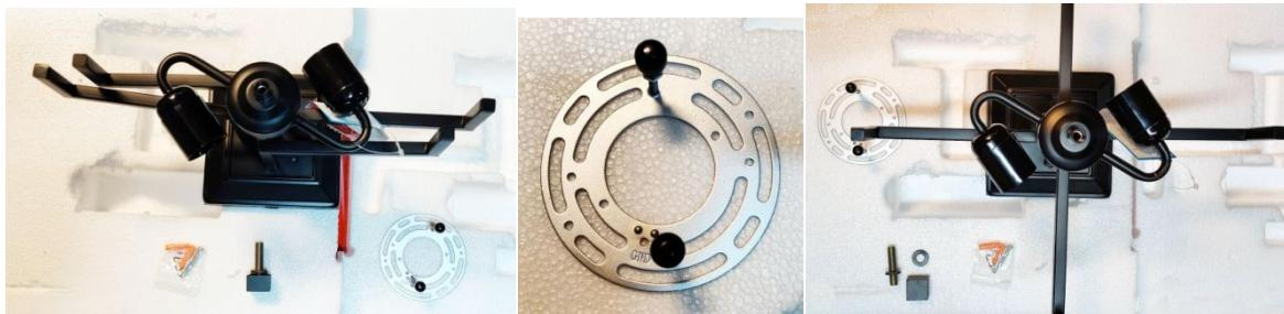
Danach kann die Verkabelung angeschlossen werden. Vorsicht: Schalten Sie zuerst die Stromversorgung des Systems aus. Montieren Sie dann das Gerät mit den 2 schwarzen M4-Muttern auf den Ring. Dann die 2 LED-Leuchten und schließlich die Tiffany-Glaskapsel platzieren. Legen Sie zuerst das Drahtstück mit der Rundmutter, dann die Kappe, dann den Gummiring und schließlich den schwarzen, quadratischen zentralen Befestigungsknopf an. Ziehen Sie ihn nicht zu stark an (Bild 4).
