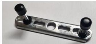
An dieser Halterung wird die Hängelampen-Pendelkonstruktion mit 2 x M4 Zierschraubenmuttern befestigt. Es empfiehlt sich, dies mit 2 Personen durchzuführen, da die elektrischen Leitungen gleichzeitig angeschlossen werden müssen. Der Anschluss der Leitungen erfolgt über die Klemmenleiste, die sich bei modernen Anschlusskästen im Anschlusskastendeckel befindet oder auf den losen Leitungen montiert wird.
